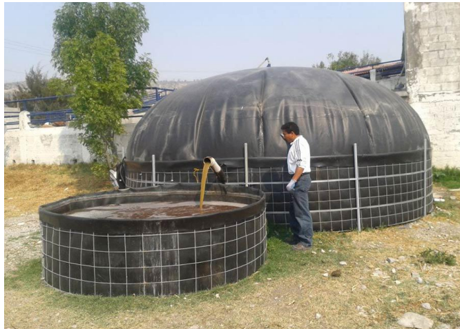
Ilustración 7. Biodigestor tipo Hindú.
