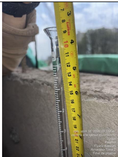
Medición de resultados prueba pipeta Karsten
