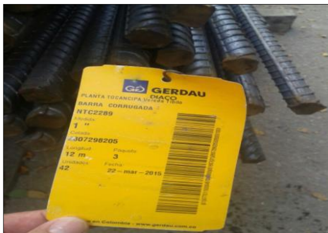
FOTO 1: Referencia acero utilizado en la armadura de Caissons K 27+500.
