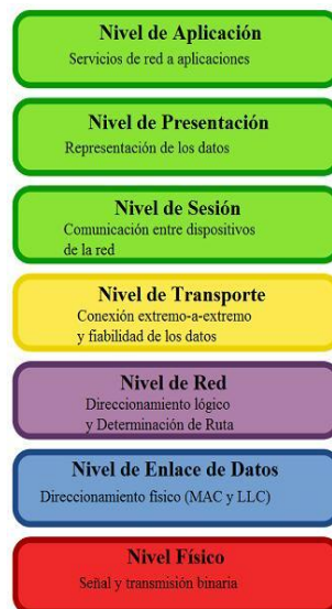
Figura 1. Estructura del modelo OSI. (Marin Moreno, Modelo OSI, 1997)
