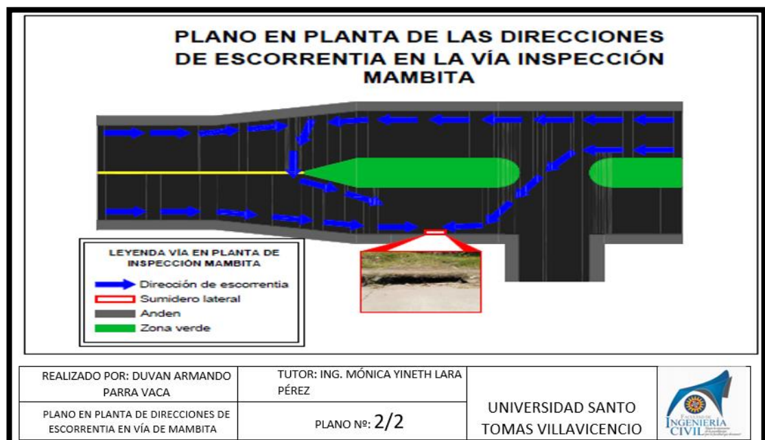
Ilustración 9.1: Direcciones que toma la escorrentía en la vía cercana al sumidero. Fuente 19: Autor.
