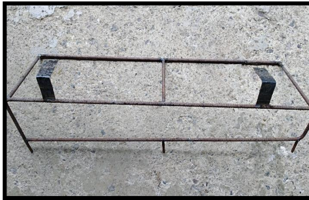
Imagen 11.2: Marco metálico para prueba de campo con la malla. Fuente 77: Autor.
