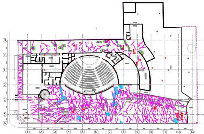
Ilustración 2. Lesiones en placa de segundo nivel
