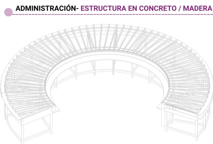
Figura 106. Estructura en concreto y madera zona administrativa y acceso
