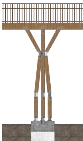
Figura 114. Columna en madera de pasarela elevada
