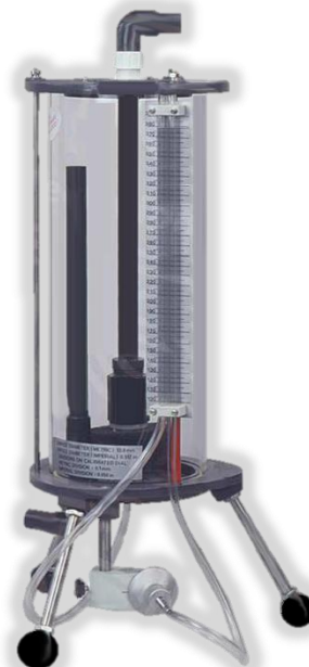
Fig. 2 Equipo para visualizar el flujo a través de un orificio
