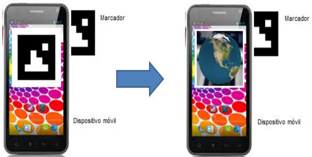
Figura 2. Funcionamiento AR basada en marcadores
