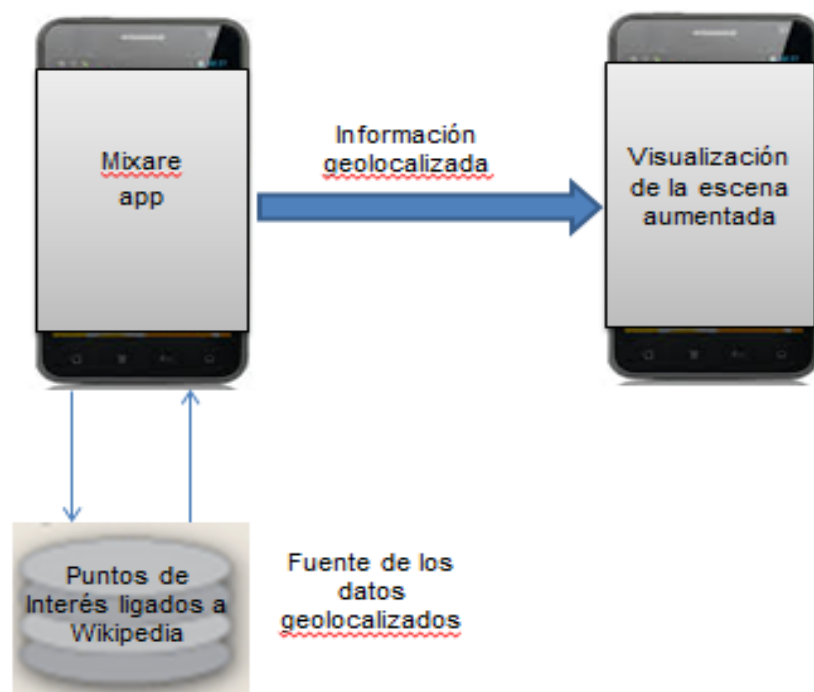
Figura 6. Funcionamiento de Mixare
