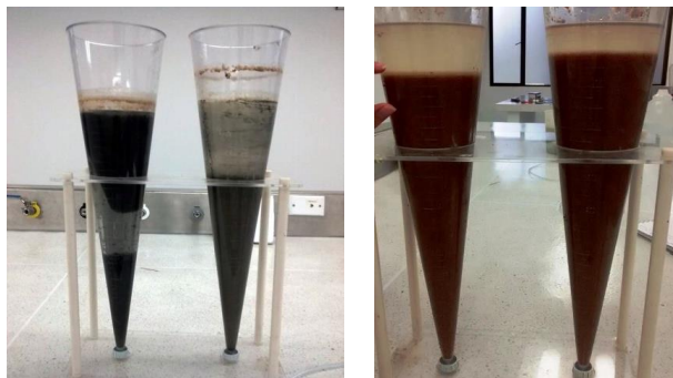
Figura 4. Sedimentación de lodo floculento y lodo granular
