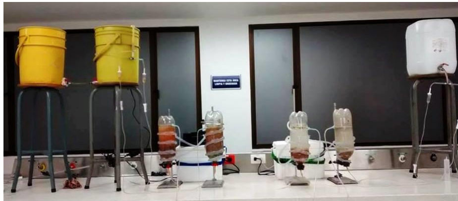
Figura 6. Montaje y arranque de Reactores Anaerobios de 2L
