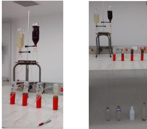
Figura 19. Montaje y arranque de Reactores Anaerobios de 0,2L
