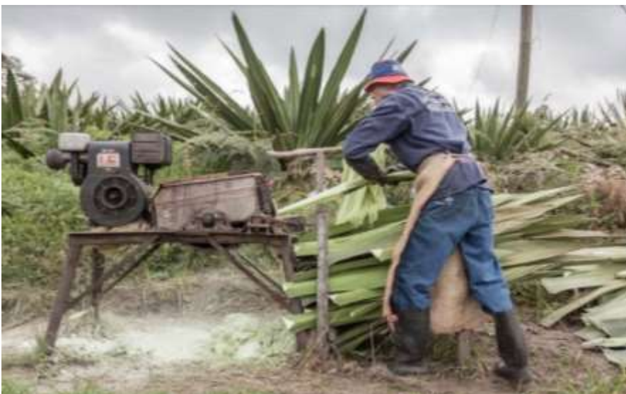
Figura 8. Desfibración de las hojas de piña
