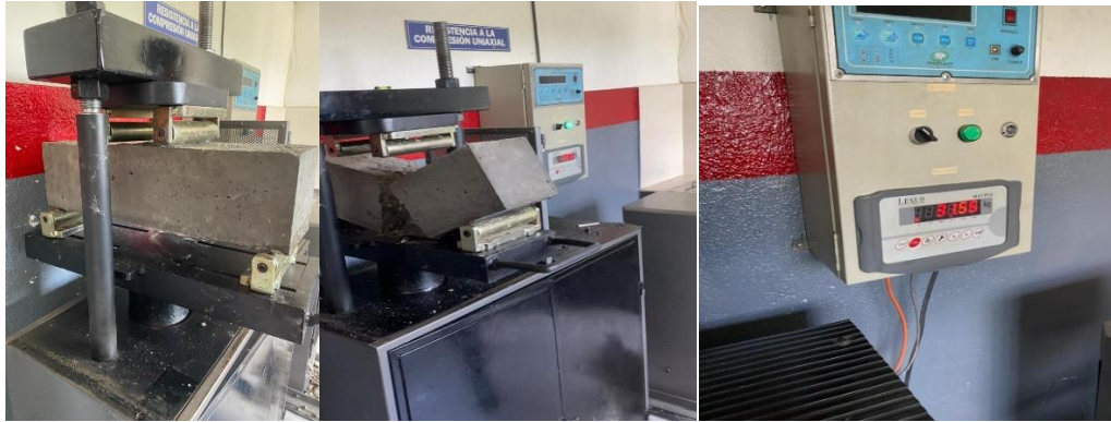
Figura 6. Prueba de resistencia a tracción en viga 1
