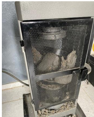
Figura 69. Falla a compresión uniaxial cilindro 1.
