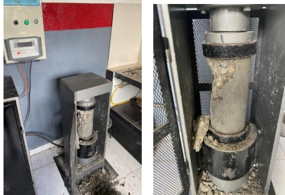
Figura 71. Falla a compresión uniaxial cilindro 3.
