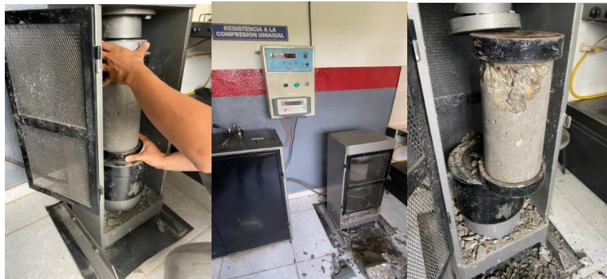
Figura 5. Prueba de resistencia a compresión uniaxial de concreto tercer cilindro
