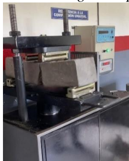
Figura 75. Falla a tracción en viga 3 con hormigón simple.
