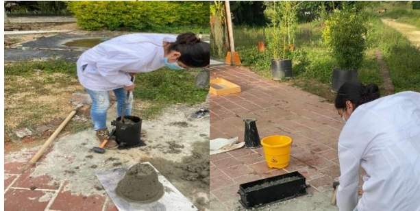
Figura 8. Vertido del concreto en las formaletas.
