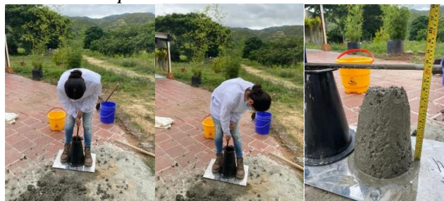
Figura 7. Ensayo de asentamiento por Cono de Abrams
