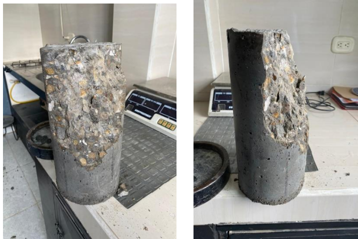
Figura 71. Falla a compresión uniaxial cilindro 3.
