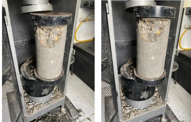
Figura 72. Falla a compresión uniaxial cilindro 3
