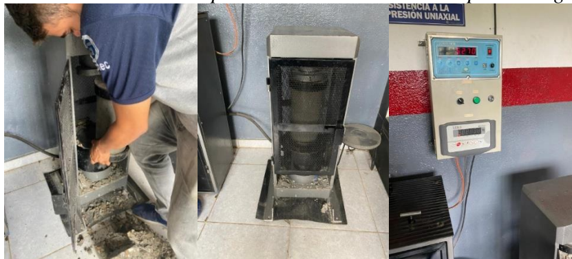
Figura 4. Prueba de resistencia a compresión uniaxial de concreto para el segundo cilindro
