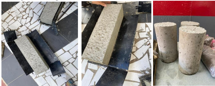
Figura 1. Desencofrado de vigas
