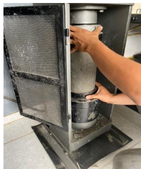
Figura 2. Prueba de resistencia a compresión uniaxial de concreto
