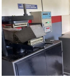
Figura 73. Falla a tracción en viga 1 con hormigón simple.
