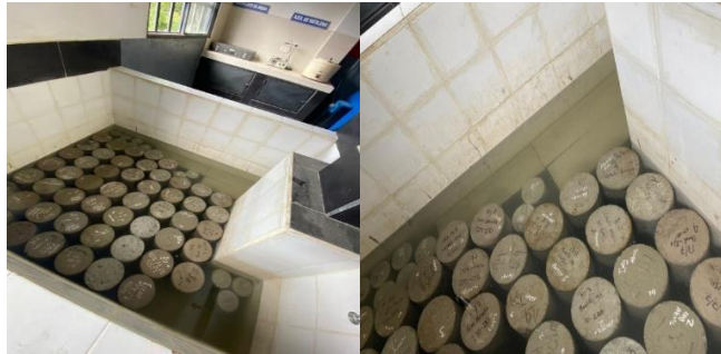
Figura 1. Etapa de curado de las vigas y cilindros.
