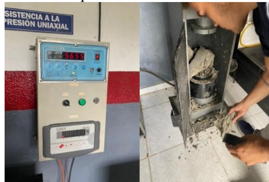
Figura 3. Prueba de resistencia a compresión uniaxial de concreto en el primer cilindro
