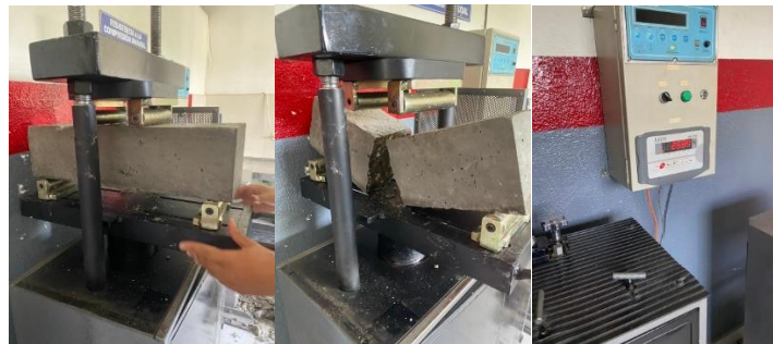
Figura 7. Prueba de resistencia a tracción en viga de hormigón 2
