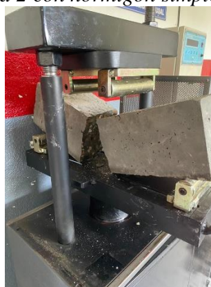
Figura 74. Falla a tracción en viga 2 con hormigón simple.
