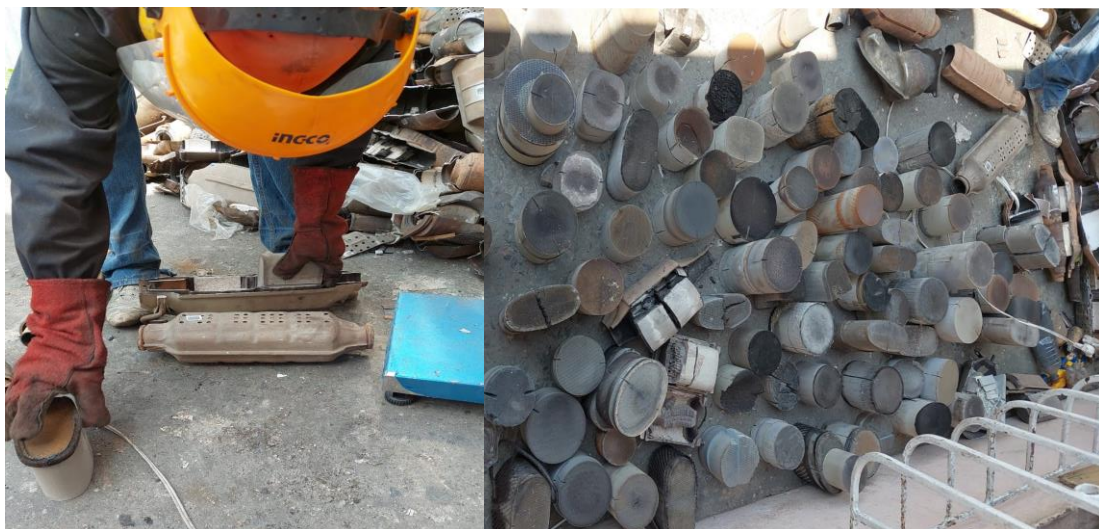
Figura 11. Corte de catalizador y extracción de cerámica
