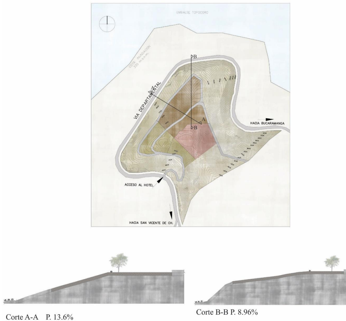
Figura 11. Cortes del terreno
