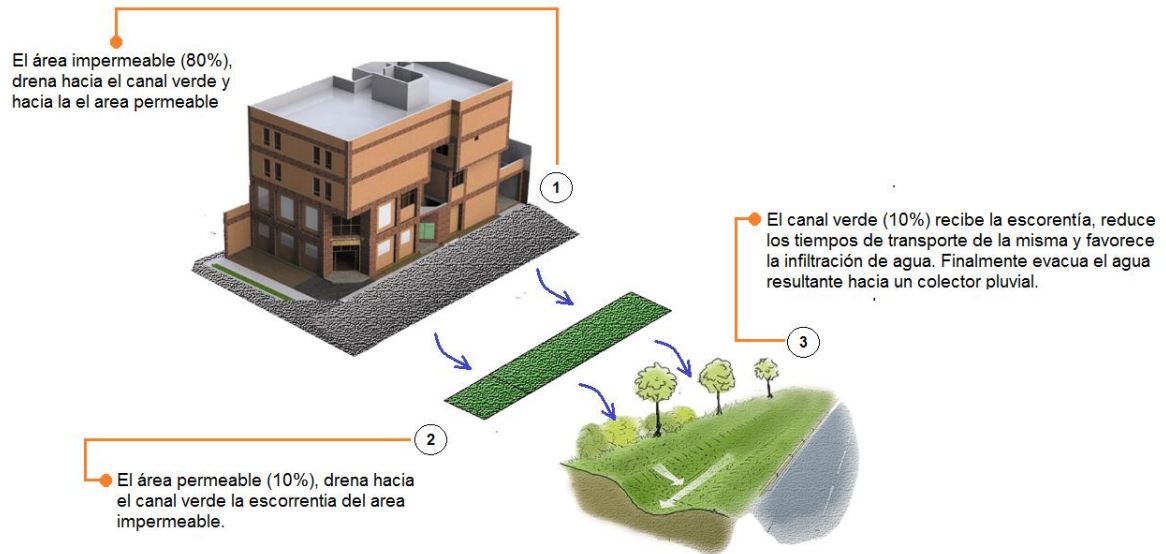
Figura 39. Drenaje dentro de subcuenca con SUDS.
