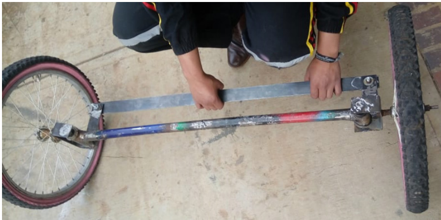
Figura 11. Sistema de dirección de un VTH de acero.
