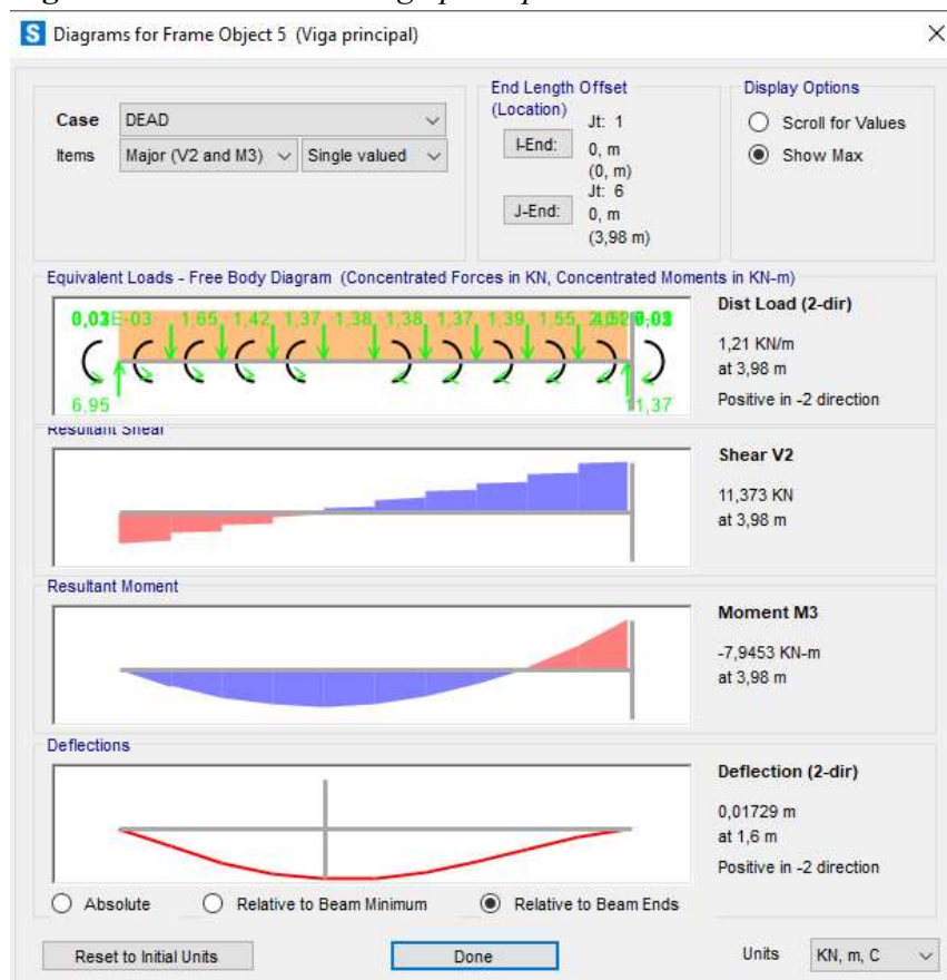
Figura 14. Resultados de viga principal con reducción el 50% de la resistencia
