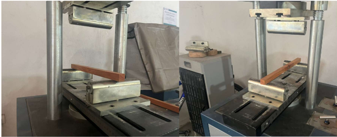
Figura 8. Realización de ensayo a flexión en probetas de madera
