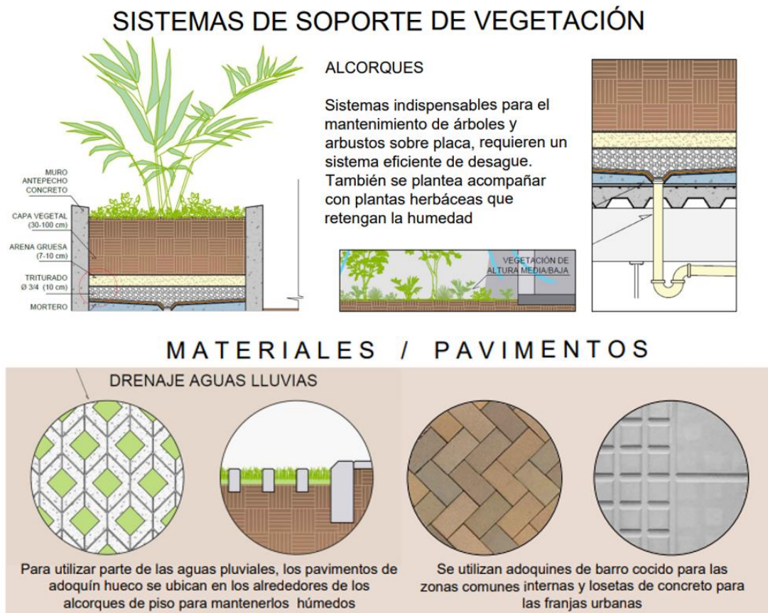
Figura 53. Sistema de drenajes y escorrentías.
