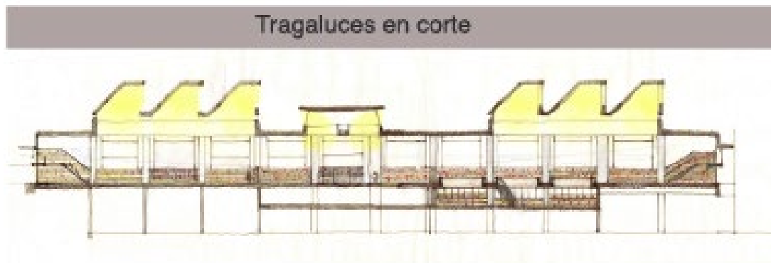
Figura 11. Propuesta de tragaluces en corte.
