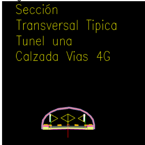
Figura 36: Sección túnel una calzada
