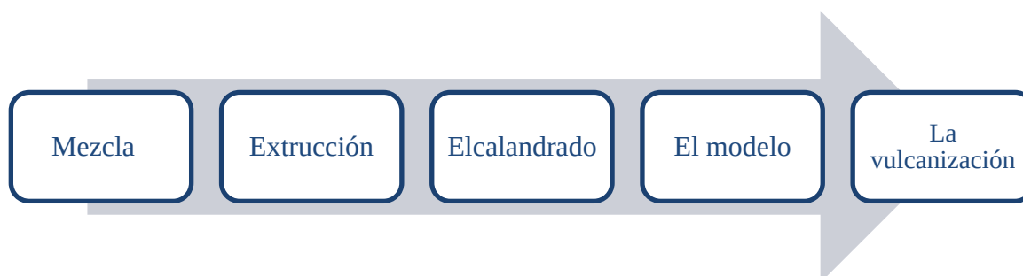
Figura 35. Procesos para la producción manufacturera del caucho. Adaptado de: DPN 2015.
