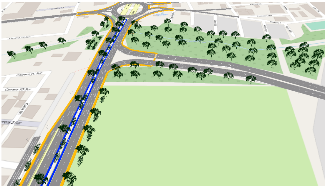
Figura 75. Modelación de la Av. calle 83 tramo 2 solución 2 Giro ingles + Glorieta Intersección Simón Bolívar Cra. 4 sur
