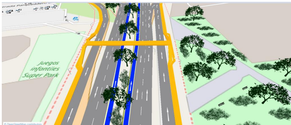
Figura 77. Modelación de la Av. calle 83 tramo 2 solución 2 Giro ingles + Glorieta Puente Peatonal cerca de la cra. 5 con Av. Calle 83 entre el éxito y home center
