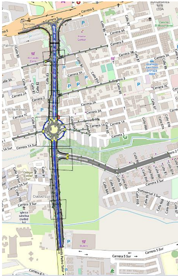
Figura 78. Modelación de la Av. calle 83 tramo 2 solución 3 Giro ingles + Glorieta holandesa
