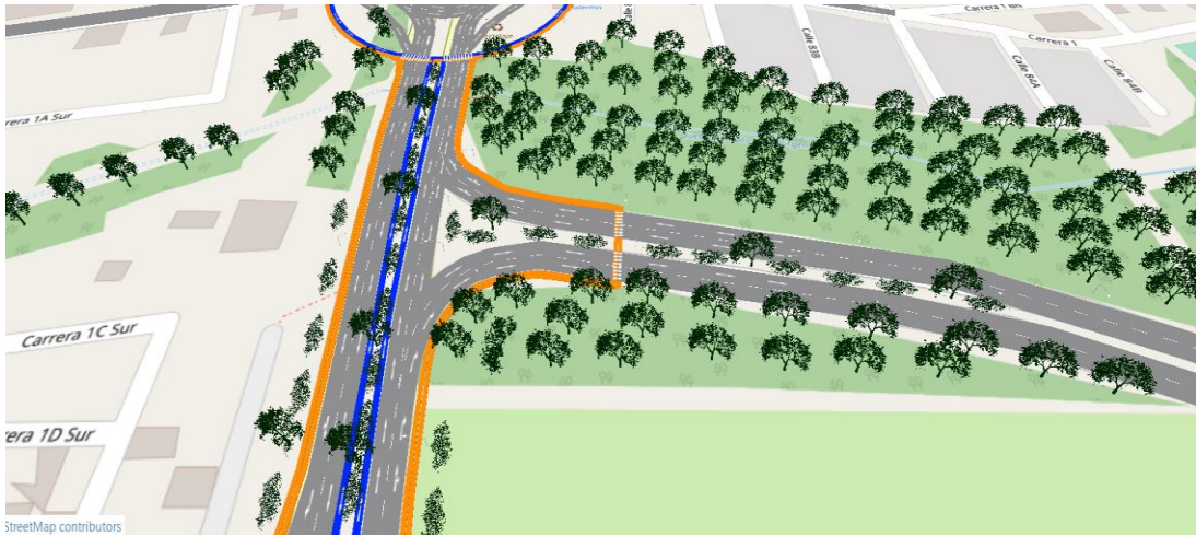
Figura 80. Modelación de la Av. calle 83 tramo 2 solución 2 Giro ingles + Glorieta holandesa Intersección Simón Bolívar Cra. 4 sur
