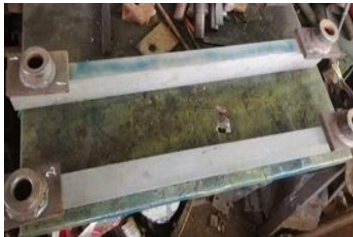
Fotografía 14. Fabricación de vigas de apoyo.
