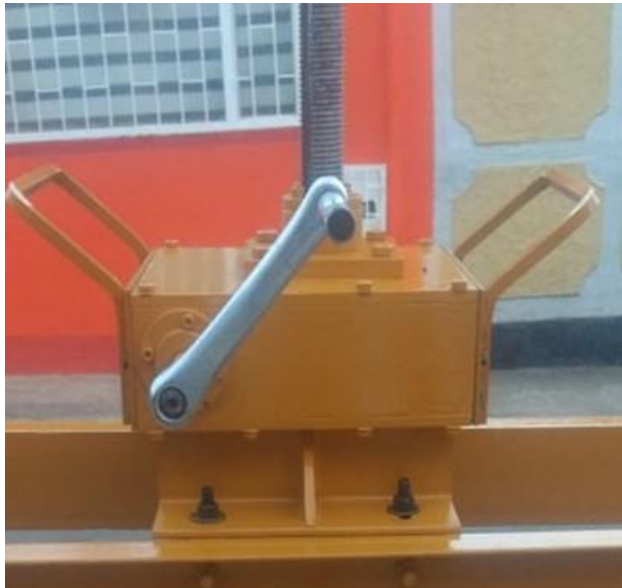
Fotografía 12. Sistema de aplicación de carga.
