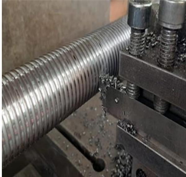
Fotografía 9. Fabricación del pistón de aplicación de carga.
