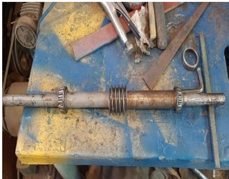
Fotografía 7. Ensamble interior de la caja eje manual.
