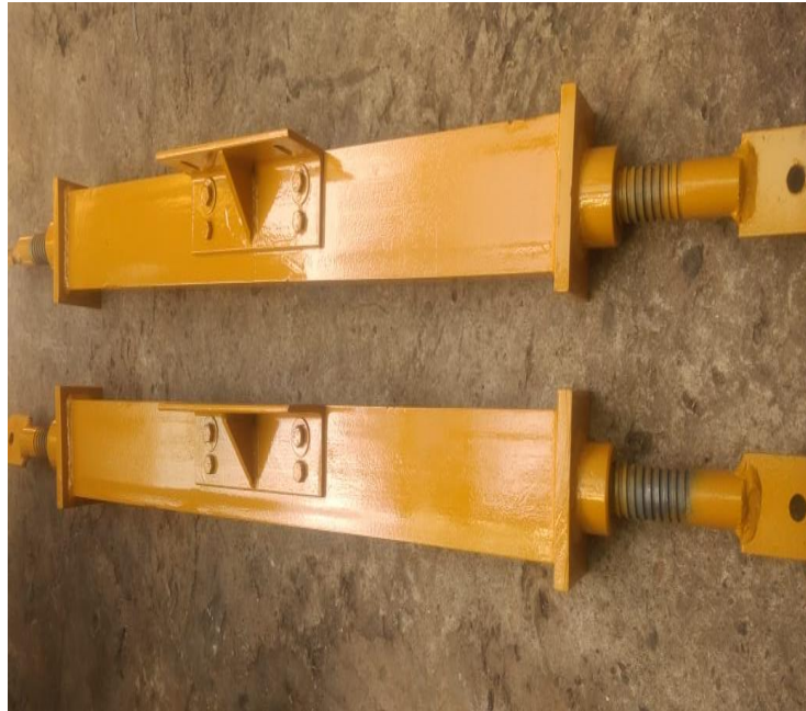
Fotografía 16. Sistema de vigas de apoyo.
