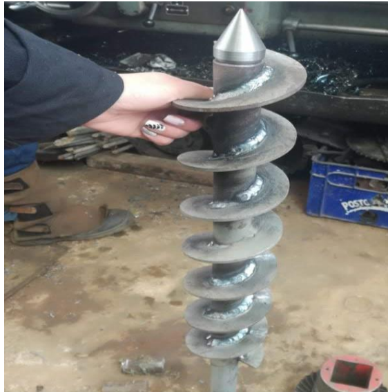
Fotografía 18. Fabricación de punta barrenos helicoidales.
