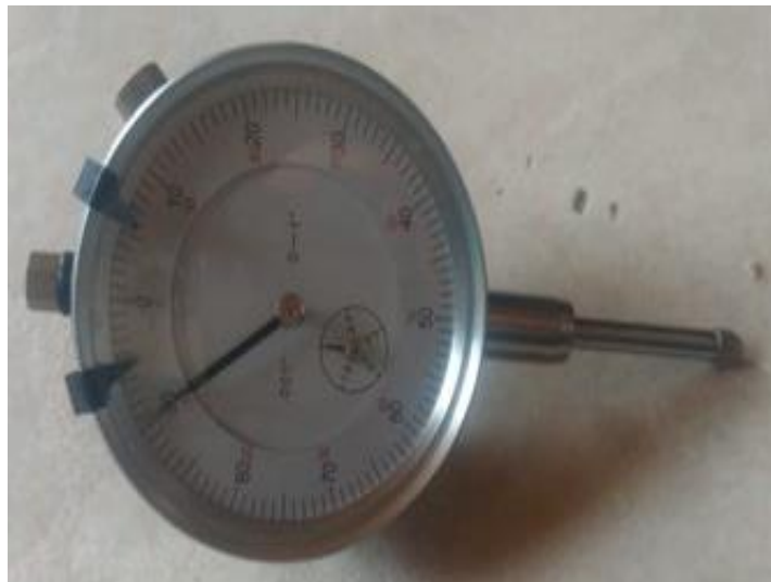
Fotografía 22. Deformimetro precisión 0.02 mm.
