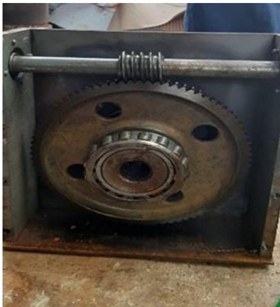
Fotografía 6. Ensamble interior de la caja.
