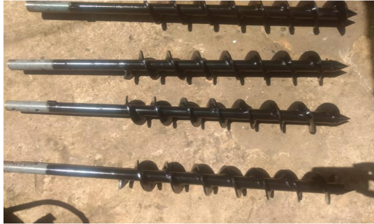
Fotografía 19. Sistema de anclaje mediante barrenos helicoidales.
