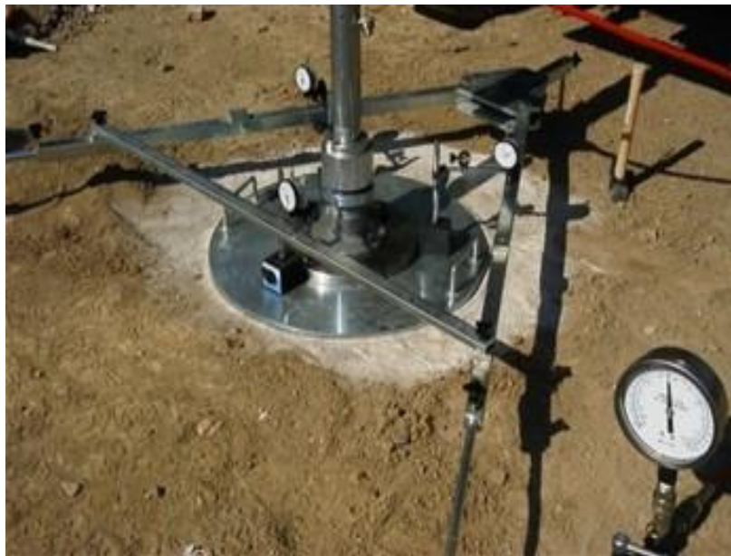
Fotografía 5. Ensayo de placa de carga estático.
