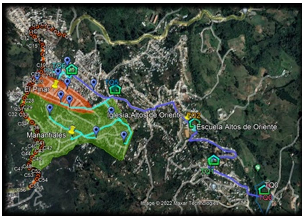
Figura 15. Esquema general del sistema de acueducto provisional de Granizal, con la línea de conducción y los tanques de almacenamiento (TQ0 a TQ6) que abastecen los sectores El Pinar y Manantiales
