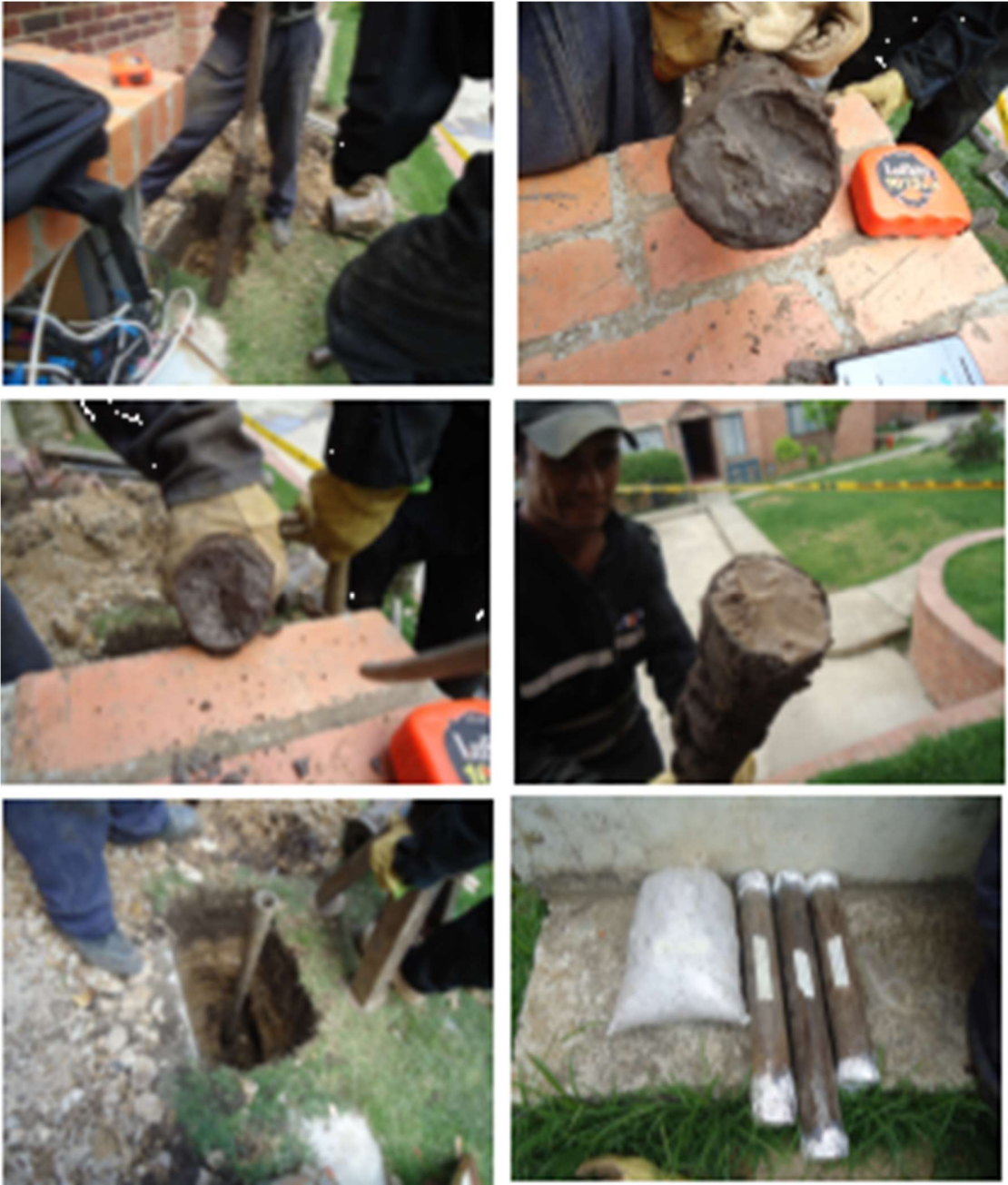
Muestras en tubos de pared delgada y cuchara partida, suelos de consistencia media, principalmente arcillas de baja compresibilidad.
