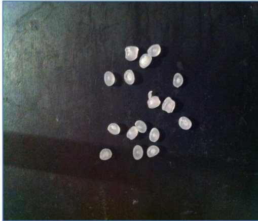
El PP original es granulado color natural transparente.
