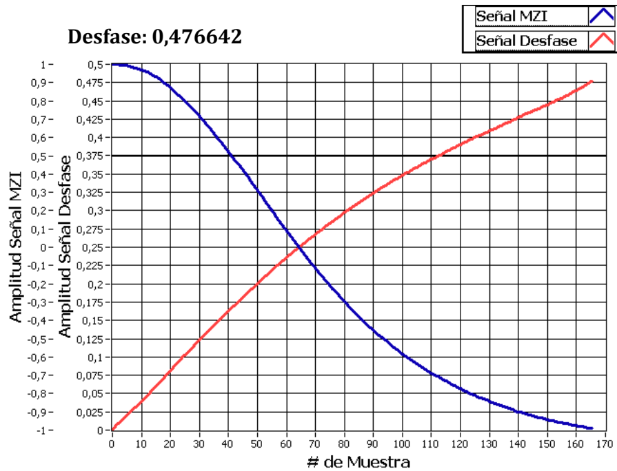
Figura 46. Ejemplo de cálculo de desfase de una señal MZI menor de \pi sin emplear referencia
