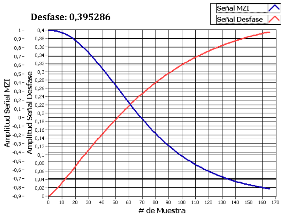
Figura 47. Ejemplo de cálculo de desfase de una señal menor de \pi MZI empleando referencia
