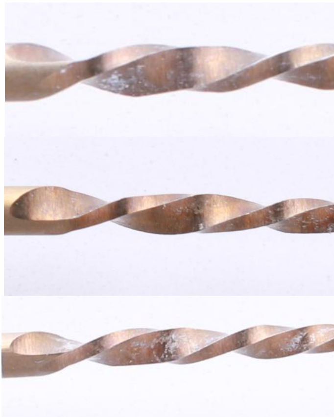
Figura 7. Presencia de Grietas en la parte activa de Limas Primary en tercio entre D11 y D16 esterilizadas con calor húmedo.
