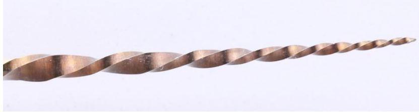
Figura 5. Corrosión y estiramiento de las estrías en lima Primary esterilizada con Calor húmedo después de 19 ciclos de esterilización.
