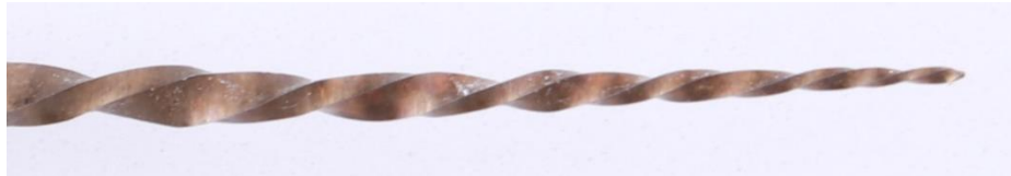
Figura 6. Corrosión y estiramiento de las estrías en lima Primary esterilizada con método químico después de 19 ciclos de esterilización.
