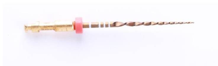
Figura 2. Fotografía lima Primary Esterilizada con calor húmedo después de 19 ciclos de esterilización.
