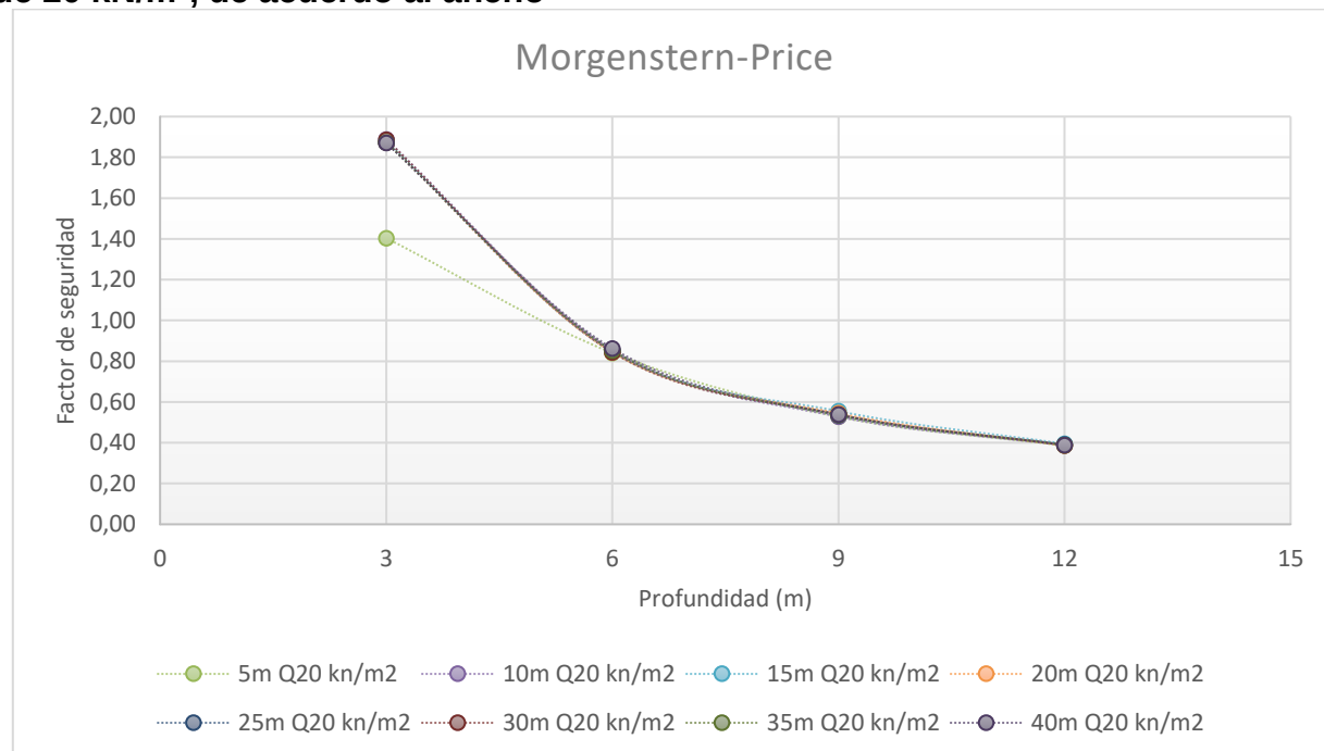
Ilustración 76. Gráfica valores de factor de seguridad vs profundidad para cargas de 20 kN/m 2 , de acuerdo al ancho
