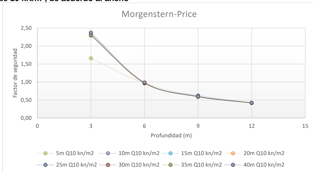
Ilustración 75. Gráfica valores de factor de seguridad vs profundidad para cargas de 10 kN/m 2 , de acuerdo al ancho
