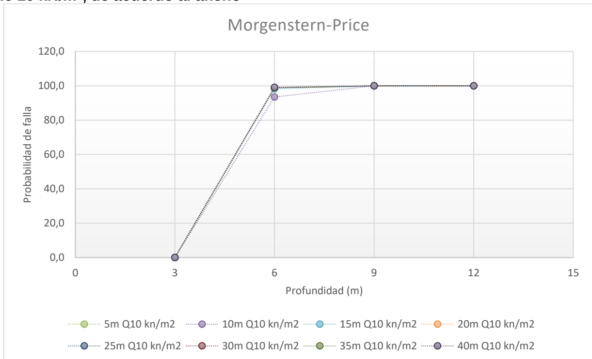
Ilustración 79. Gráfica valores de probabilidad de falla vs profundidad para cargas de 10 kN/m 2 , de acuerdo al ancho
