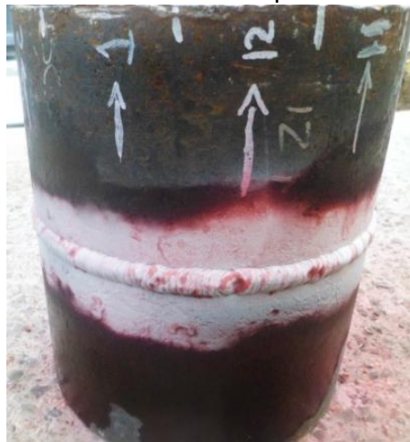
Figura 29 Discontinuidades presentes en la tubería.
