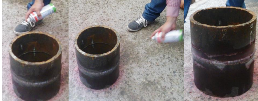
Figura 28 Aplicación del líquido Revelador
