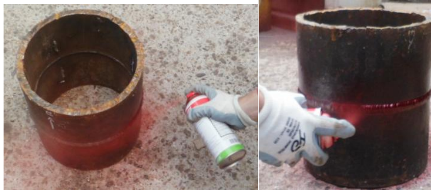
Figura 26 Aplicación de Penetrante
