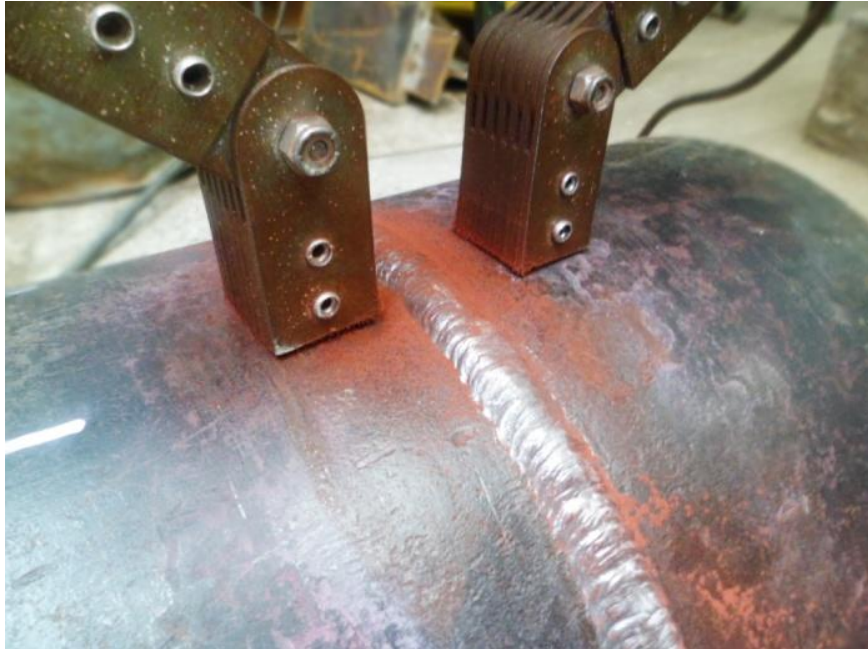
Figura 15 Magnetización del Material
