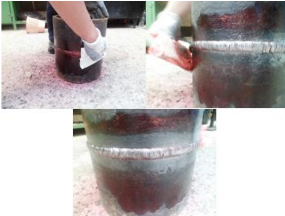
Figura 27. Remoción con retal de tela del exceso de penetrante
