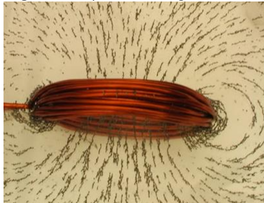
Figura 14 Esquema de Magnetización Indirecta.
