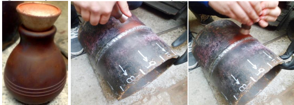
Figura 36 Aplicación de Partículas Secas Rojas
