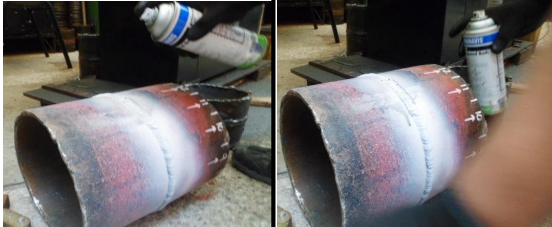
Figura 45 Aplicación de partículas Magnéticas Húmedas
