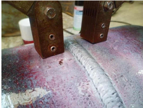
Figura 46 Posicionamiento del Yugo sin encender
