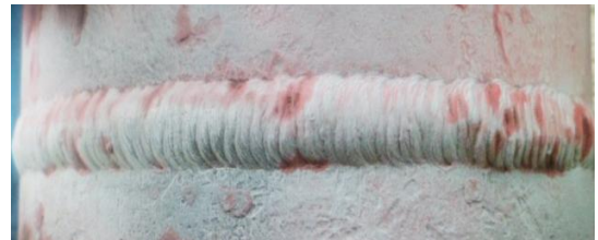
b) Porosidad Aislada, junto con socavado.
