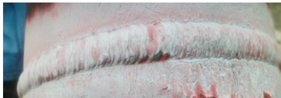
c) Porosidad Aislada, junto con falta de Fusión
