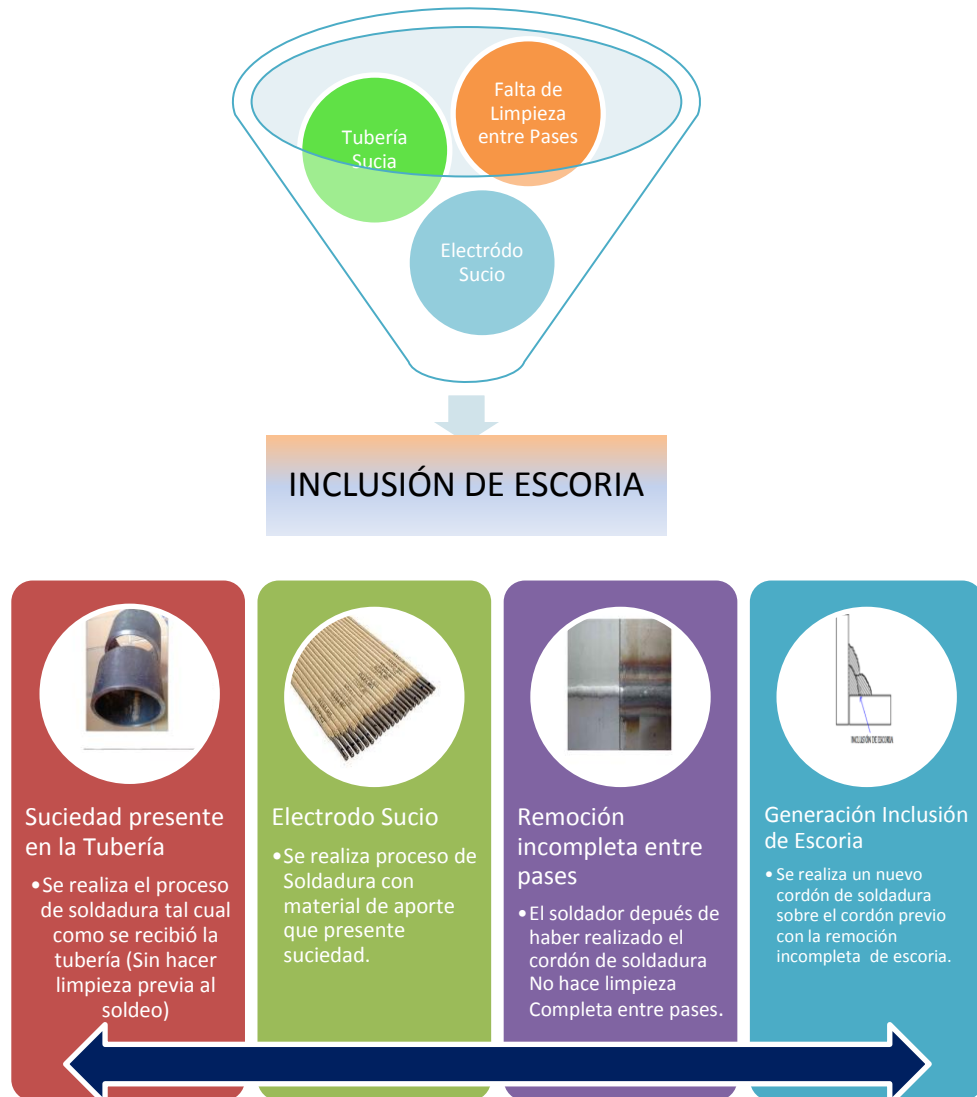
Figura 19 Proceso de Generación de Inclusión de Escoria.
