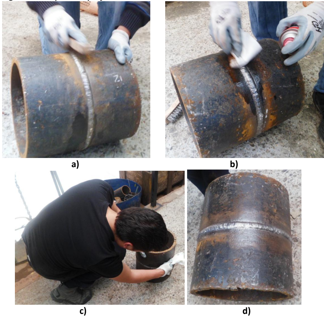
Figura 34 Limpieza superficial del tubo
