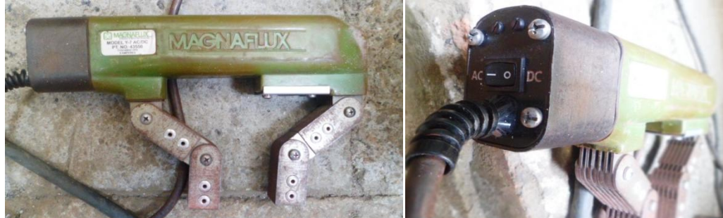
Figura 35 Tipo de corriente de Magnetización
