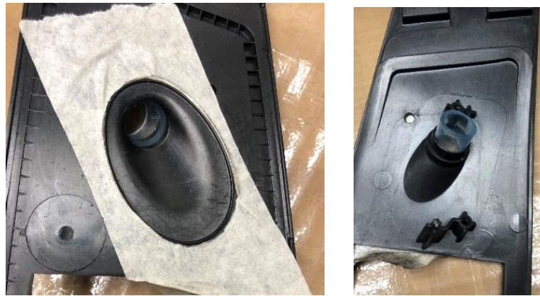
Figura 49. Preparación de piezas, se coloca masking tape alrededor del área a flochar. Fuente propia 2019
