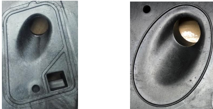
Figura 19. Zona de flocado pieza REVESTIMIENTO POSTE B AT RH y RH ASY-MS-B PILLAR.
