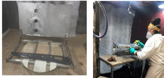
Figura 27. herramental de la pieza y el área de aplicación de adhesivo. Global Flock 2019
