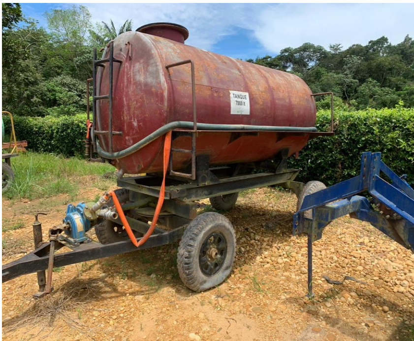
*Tanque con motobomba de 7000 litros.
