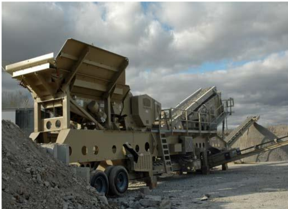
Figura 4. Planta portátil de trituración y clasificación de material modelo JCP 2238-38
