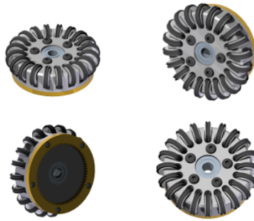
FIGURA 5: Diagrama de las ruedas en los robot STOX's , tomado de [38]
