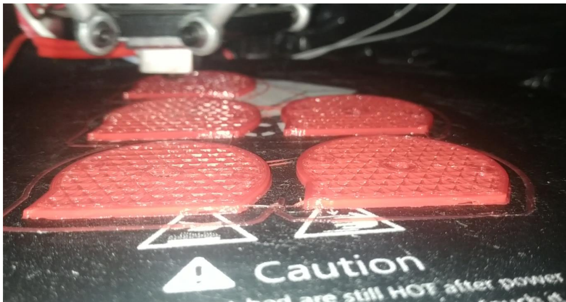
Figura 14.10 Imprimiendo el soporte fijo Version Final. Fuente: Autor.
