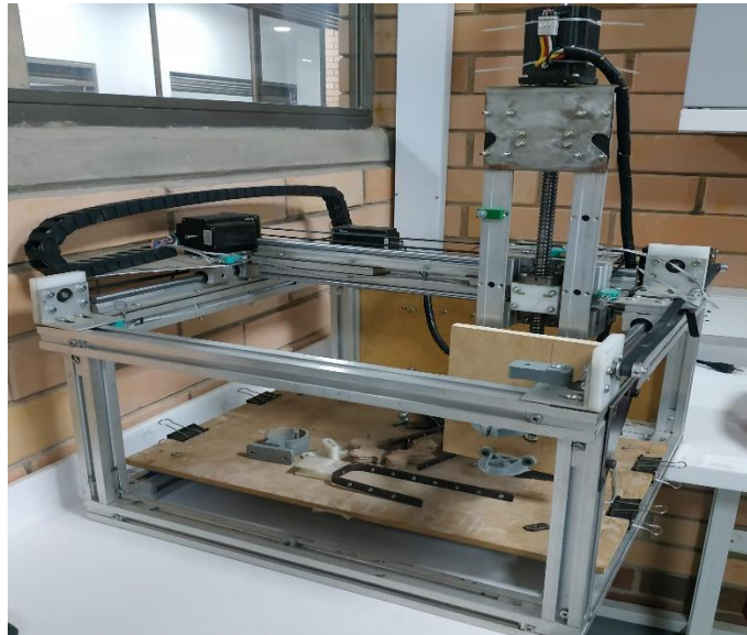
Figura 9.1 Estructura CNC de los laboratorios de Ingeniería Mecánica a la que se le aplicó el control. Fuente: Autor.
