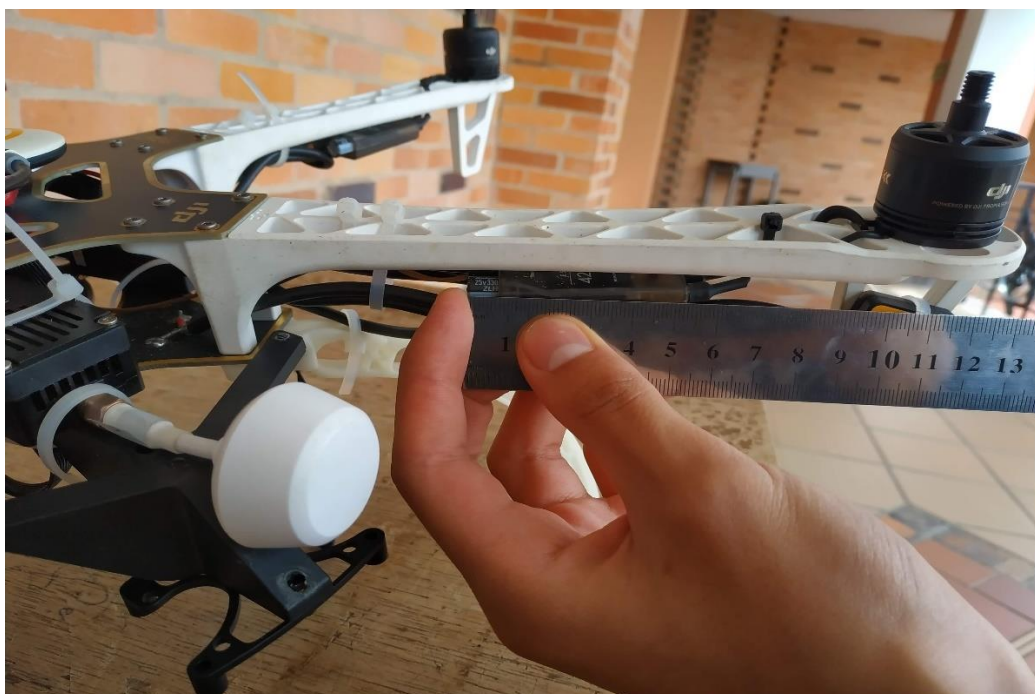
Figura 14.8 Toma de medidas de la distancia del soporte al controlador. Fuente: Autor.
