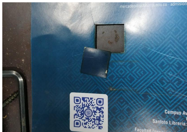
Figura 13.15 Pruebas grabado láser en papel. Fuente: Autor.
