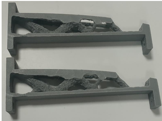
Figura 11.17 Vista lateral de los soportes impresos en 3D para la fuente de poder de 12V.
