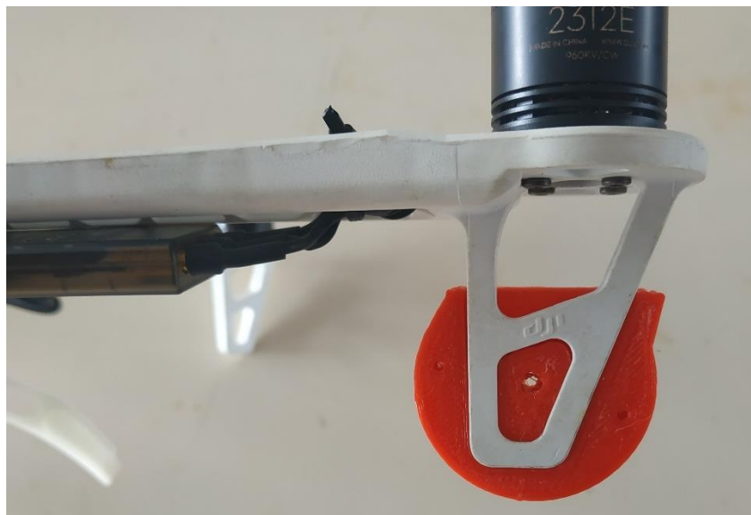
Figura 14.12 Fabricación del soporte fijo Version Final. Fuente: Autor.
