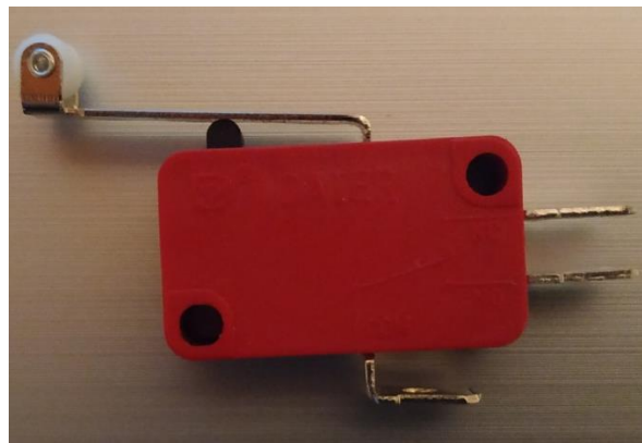
Figura 11.26 Fines de curso del sistema de control modular. Fuente: Autor.
