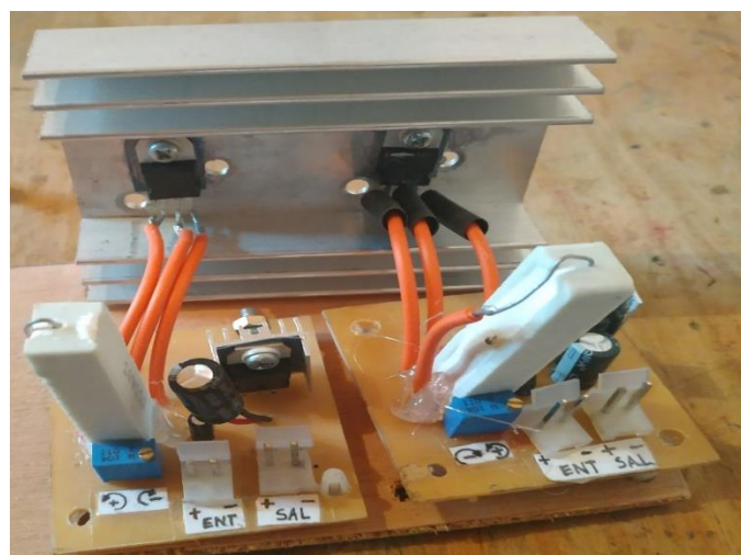
Figura 11.10 PCB del bypass transistorizado. Fuente: Autor.
