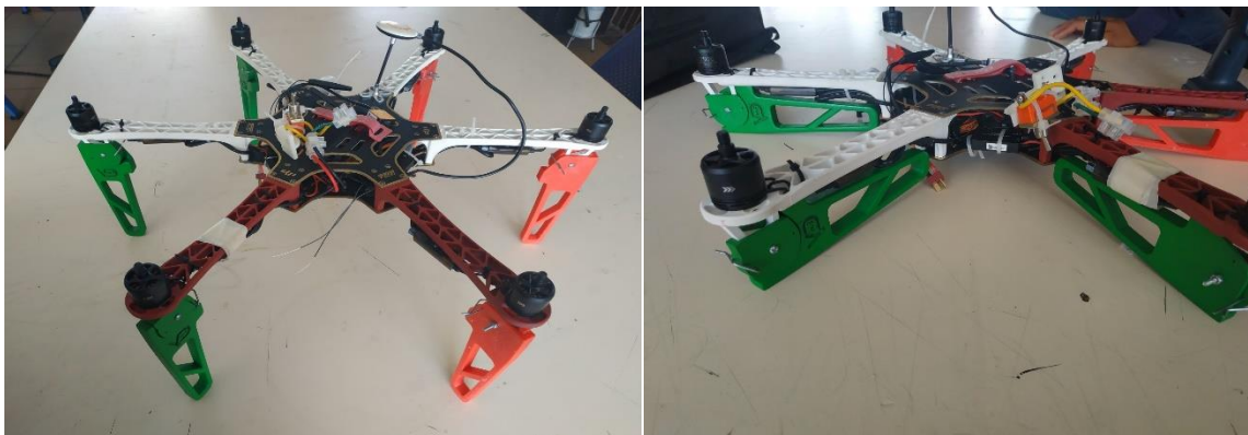
Figura 14.14 Tren de aterrizaje desplegado y plegado del dron. Fuente: Autor.
