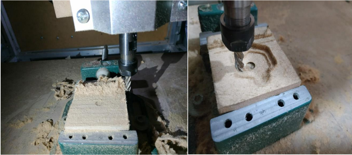
Figura 13.8 Prueba de Refrentado y de geometría Hexagonal. Fuente: Autor.
