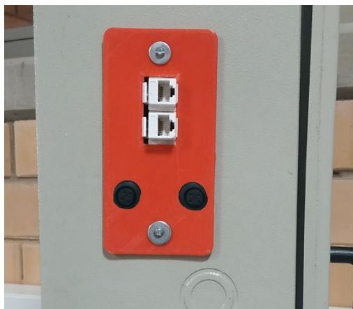
Figura 11.28 Acoples fines de curso, resistencia de hotend, termistor, ventilador de hotend y conexión pwm de láser acoplados al chasis. Fuente: Autor.
