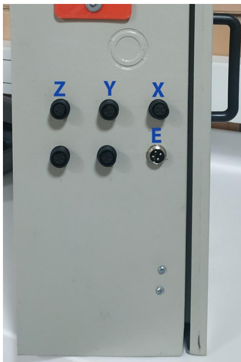
Figura 11.22 Acoples de motores paso a paso colocados en el chasis. Fuente: Autor.
