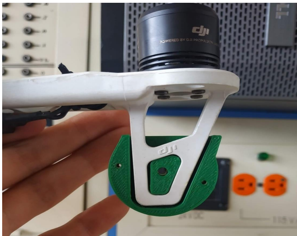
Figura 14.3 Diseño del soporte fijo Version 1. Fuente: Autor.
