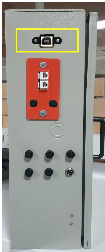
Figura 11.30 Acople de comunicación serial del sistema de control modular al computador. Fuente: Autor.
