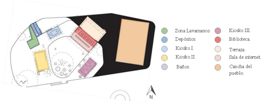
Figura 17. Planta arquitectónica La Casa del Pueblo.
