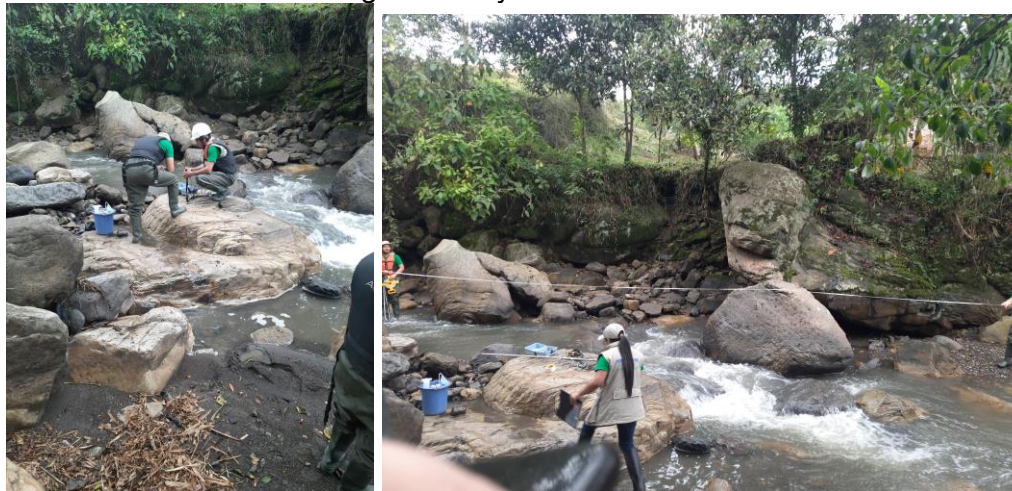
Figura 24. Visita Quebrada la Quigua Aforo y Prueba de Trazadores
