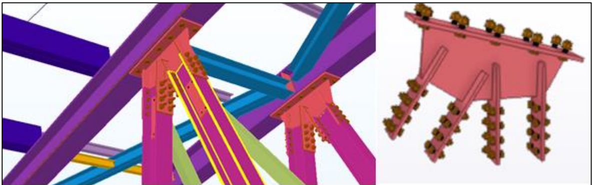
Figura 22. Fijación de muñones mediante conexión end-plate
