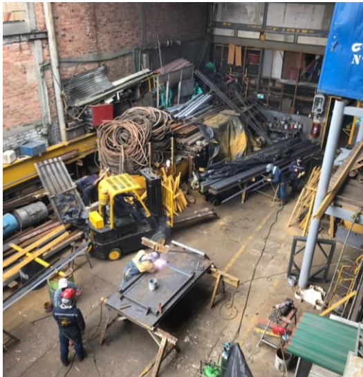
Figura 7. Supervisión de corte y ensamble de material en el taller
