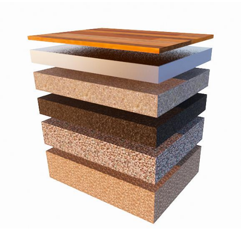
Figura 48. Detalle en 2D de placa de hormigón con aislamiento en poliestireno extruido
