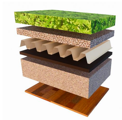
Figura 46. Detalle en 3D de cubierta verde
