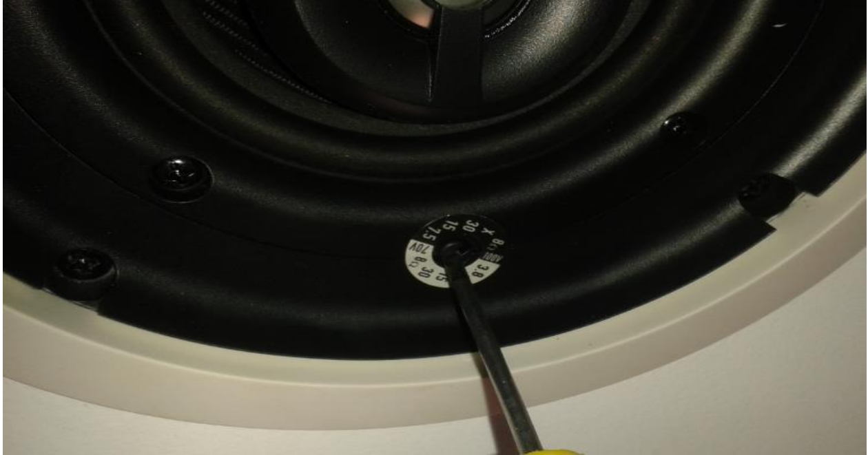
Anexo 15. Configuración del bafle a 70v-30w.
