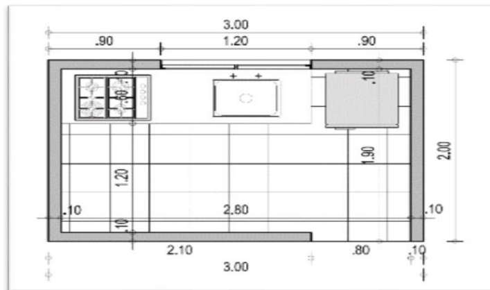
Figura19. Área requerida para la cocina
