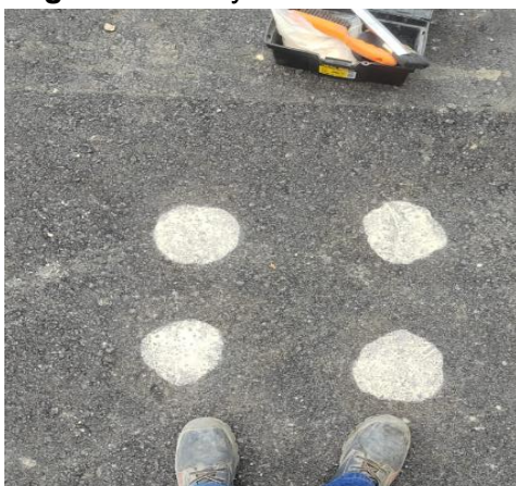
Figura 4. Ensayo Circulo de Arena.
