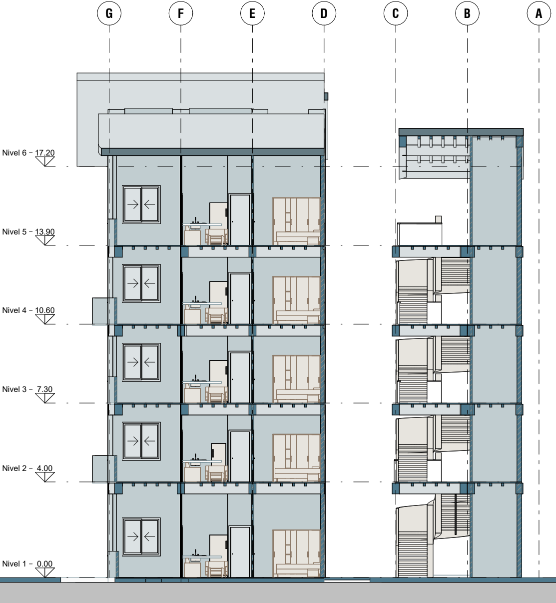
SECCIÓN ARQUITECTONICA C-C' SCL 1:100
