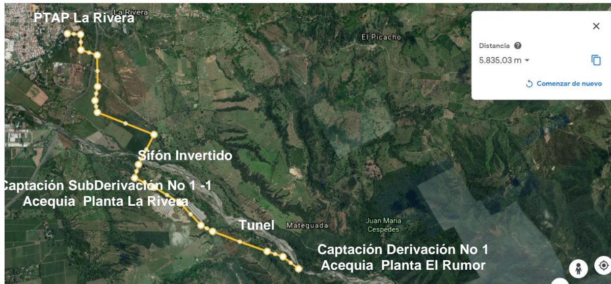
Imagen 2. Recorrido Bocatoma – PTAP.
