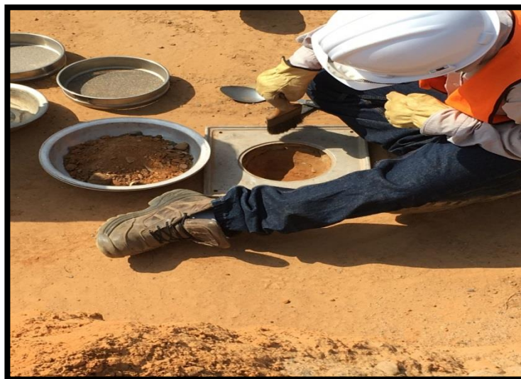
Fotografía 23. Toma de ensayo de densidades.
