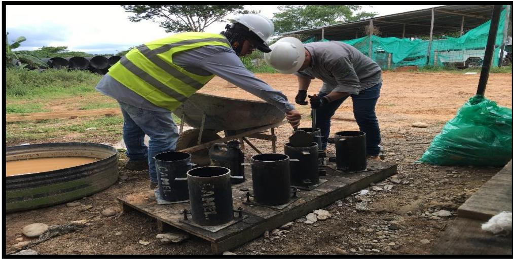
Fotografía 68. Toma de muestras de cilindros de concreto de 4000 psi
