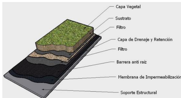
Ilustración 6.1 Componentes de la cubierta verde.
