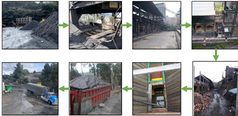
Ilustración 3. Diagrama de flujo proceso de coquización
