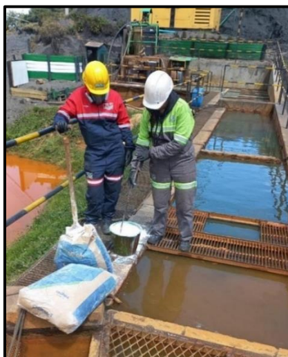
Ilustración 6. Preparación de lechadas de Cal
