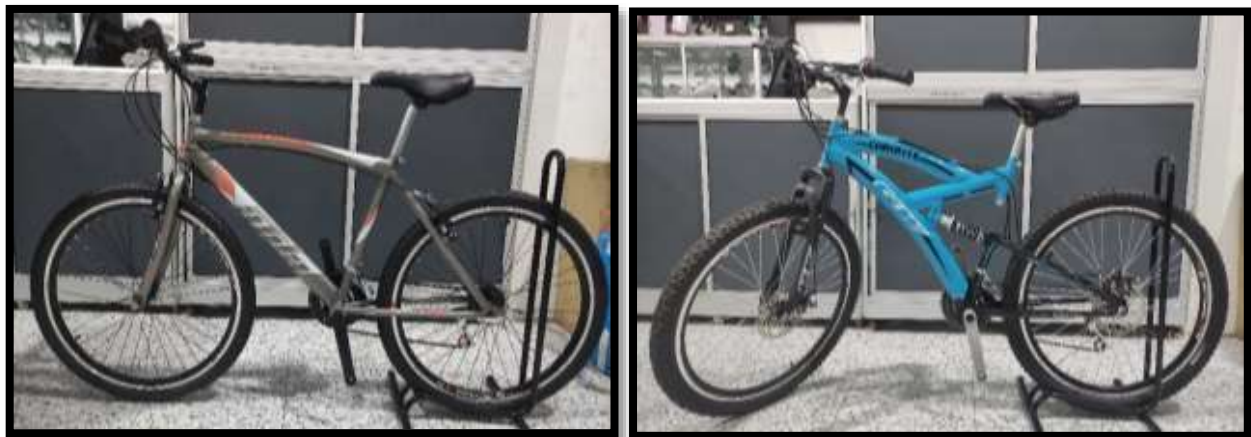
Figura 13. Bicicletas todo terreno de 26 pulgadas con marco rígido y con suspensión de amortiguador delantero y trasero.
