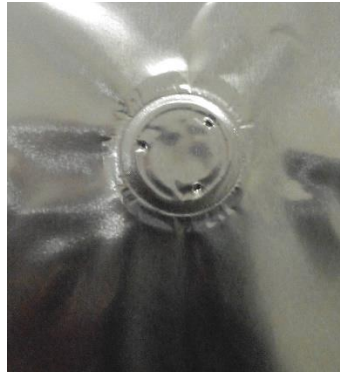
Figura 12. Válvula Desgasificadora - (Cara Externa)
