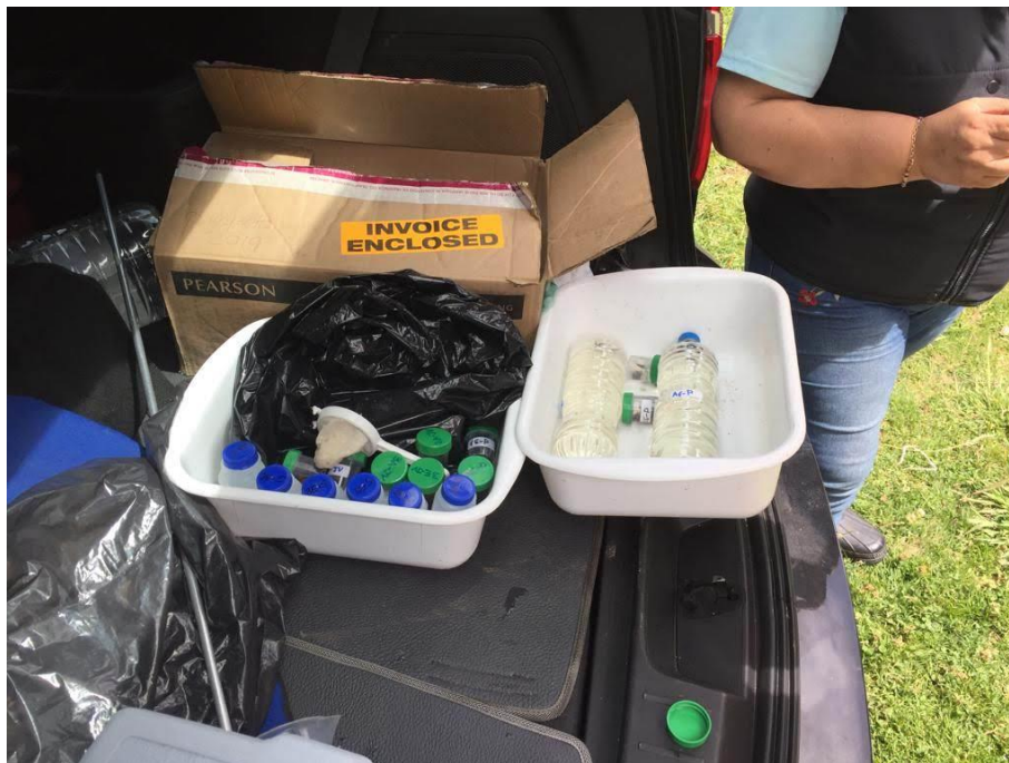
Anexo 5. Embalaje final de las muestras de agua, en bolsa oscura y en nevera.
